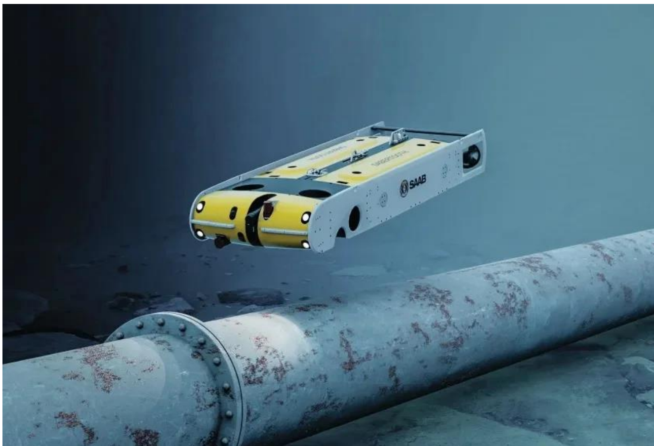
Fig.3 Sabertooth, veicolo subacqueo sviluppato da Saab (fonte SAAB)
