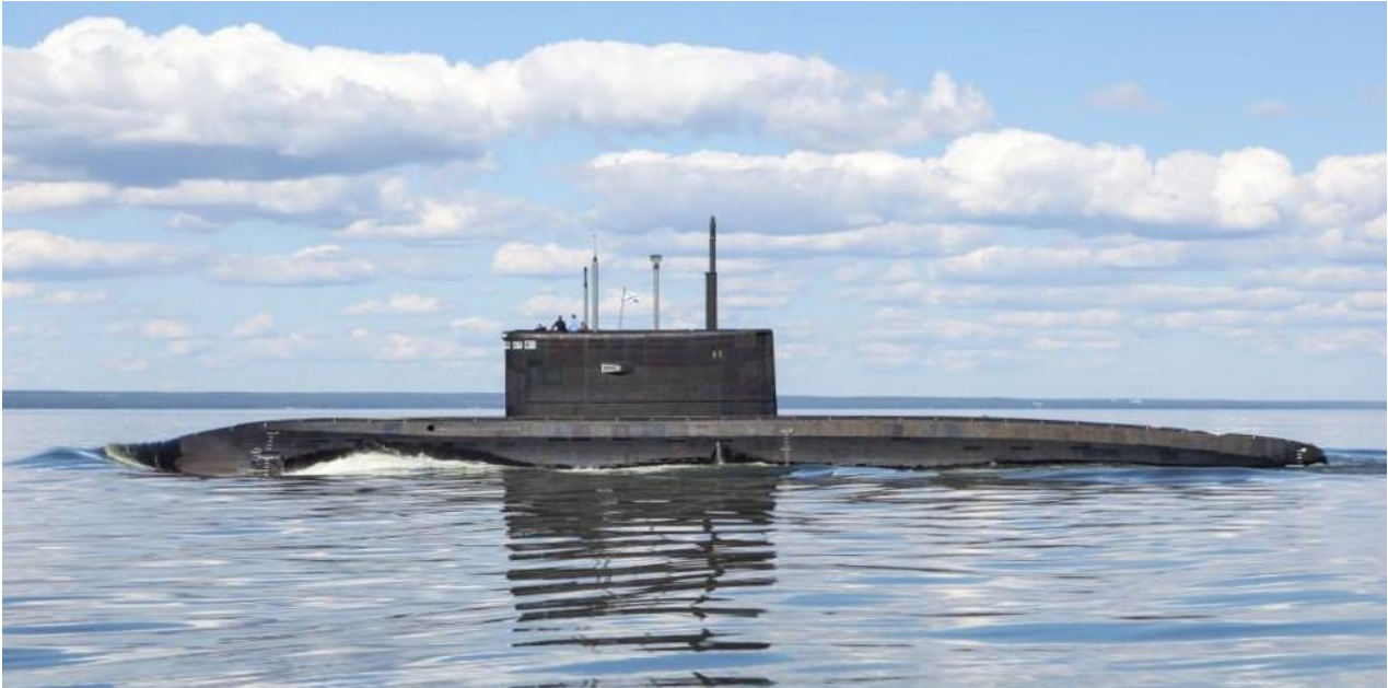
Fig.7 – Sottomarino classe KILO. Lunghezza: 73.8 m (242 ft); larghezza: 9.9 m (32 ft); dislocamento: 2350 tonnellate in superficie, 3100 tonnellate in immersione; velocità: 11 nodi in superficie, 19 nodi in immersione; massima profondità operativa (stimata): 250 m; armamento: 6 tubi lanciasiluri da 533 mm in grado di lanciare anche missili da crociera Kalibr. (Fonte: Navalpost)
