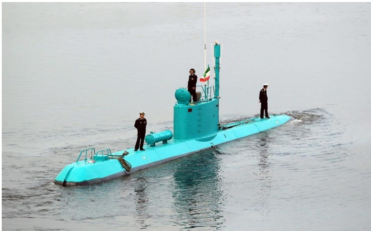
Fig.8 – Sottomarino iraniano classe GHADIR. Lunghezza: 29 m (95 ft); larghezza 2.75m (9 ft); dislocamento: 130 tonnellate in immersione; velocità stimata: 10 nodi in superficie, 4 in immersione. È in grado di trasportare 7 persone di equipaggio oltre a 6 operatori delle forze speciali. (Fonte: TimesofIsrael)
