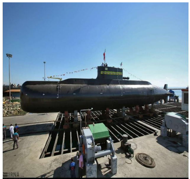
Fig.10 – Sottomarino iraniano classe FATEH. Lunghezza 48 m (157 ft); larghezza 4m (13 ft); dislocamento stimato 300 tonnellate in superficie; velocità 11 nodi in superficie, 14 nodi in immersione; massima profondità operativa (stimata): 200 m; propulsione diesel-elettrica con 1 elica; armamento: 4 tubi lanciasiluri da 533 mm. (Foto: IRNA).
